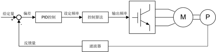
图 5.36 PID 控制基本原理框图
