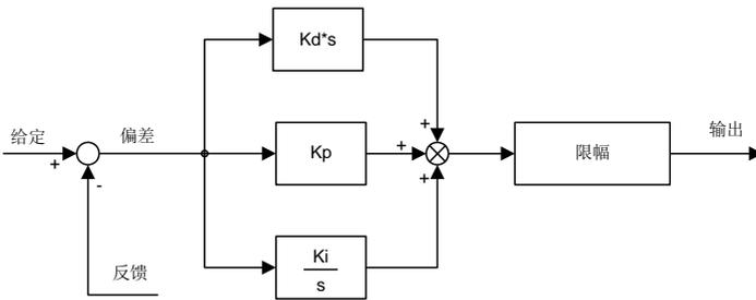
图 5.37 PID 调节器框图
