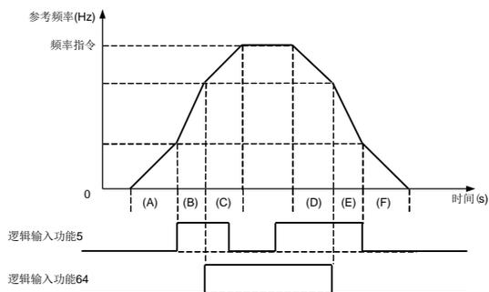
图 5.32 通过逻辑输入切换加速/减速曲线
