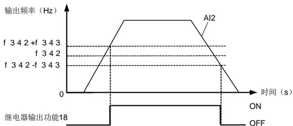
图 5.16 继电器输出-AI2 输入检出示意图
