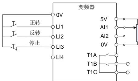
图 4.8 3 线控制（负逻辑、减速停机）接线示意图
