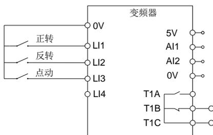
图 4.12 点动控制接线示意图
