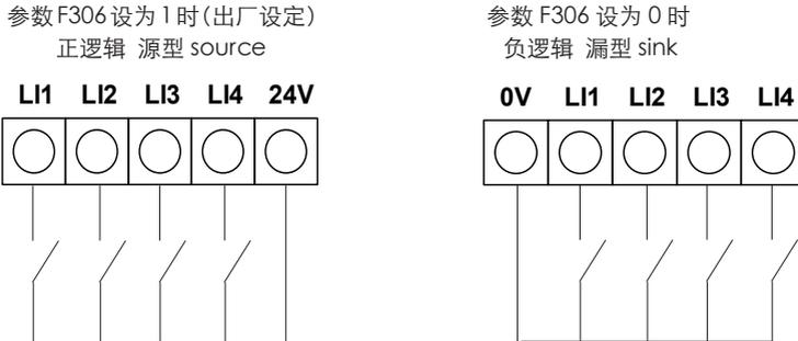
\* 注意：变频器本体输入点接线，使用内部 24V。
