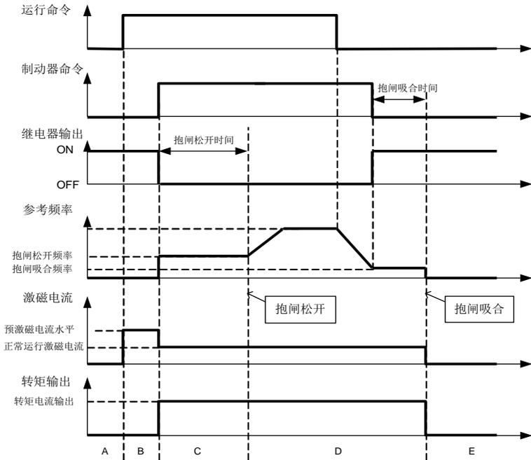
图 5.35 制动器逻辑时序示意图
