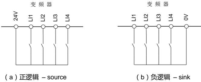
图 3.9 逻辑输入端子接线图
