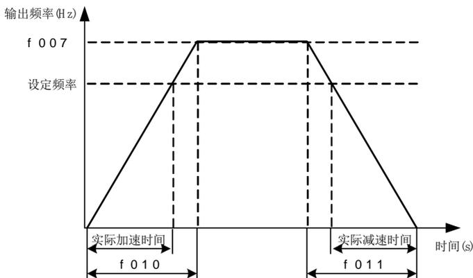
图 5.3 加速时间和减速时间定义
