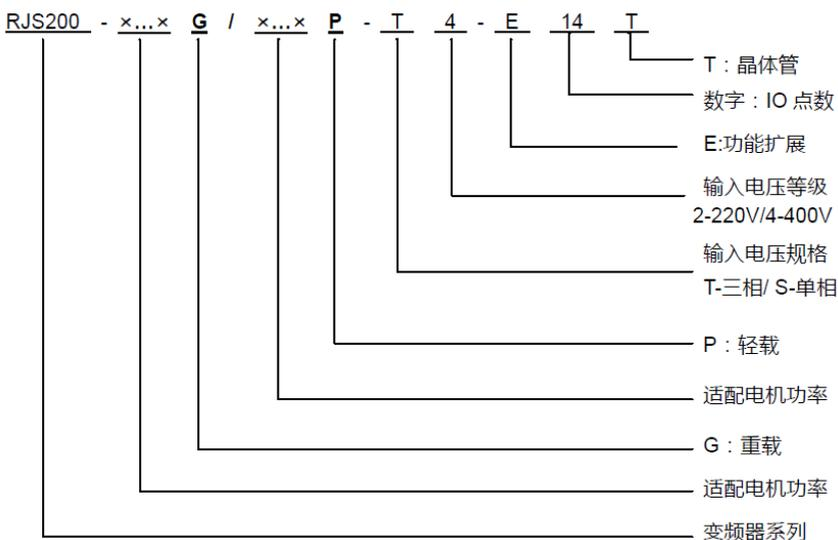
图 2.2 变频器型号说明示意图
