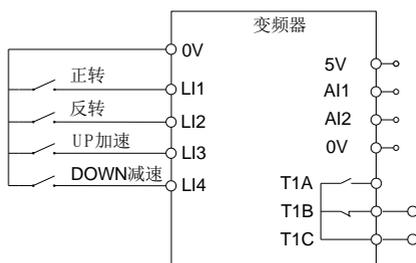
图 4.10 UP/DOWN 加减速接线示意图
