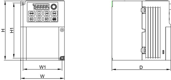
图 2.4 外形及安装尺寸图 (单相、三相 11kW (含) 以下)
