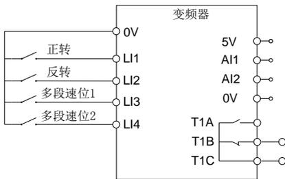
图 4.11 多段速控制接线示意图
