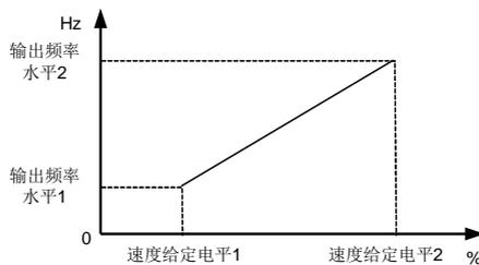
图 5.11 模拟输入和频率给定关系示意
