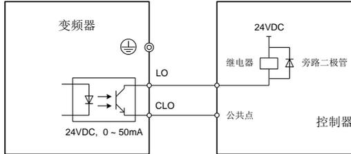
图 5.9 集电极逻辑输出接线示意图
