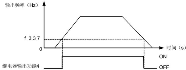
图 5.13 继电器输出-低速频率检出示意图
