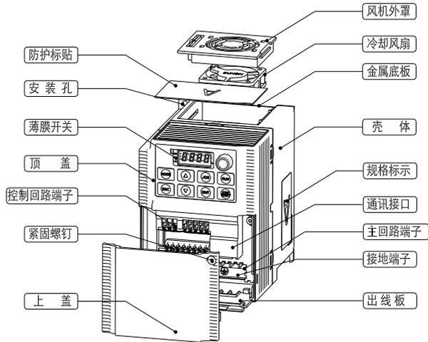
(a) 11kW (含) 以下外形结构图
