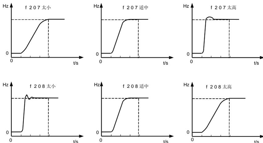
图 5.6 速度环参数与速度响应关系
