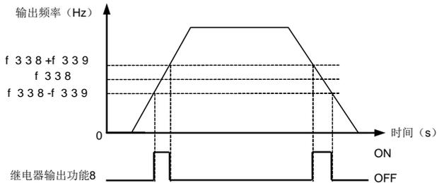
图 5.14 继电器输出-频率检出 2 示意图
