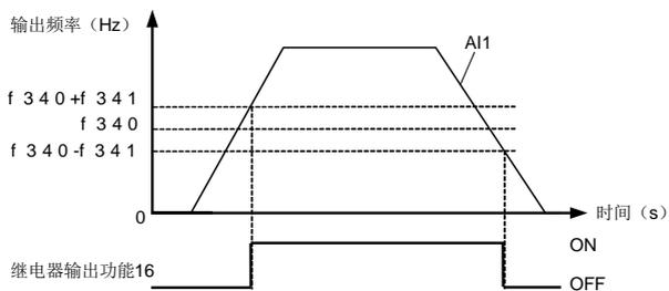
图 5.15 继电器输出-AI1 输入检出示意图
