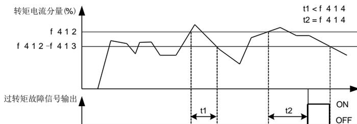
b) 过转矩故障输出信号示意图
