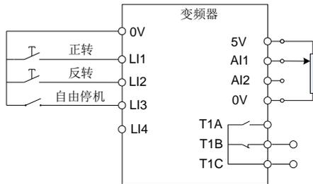
图 4.9 3 线控制（负逻辑、自由停机）接线示意图
