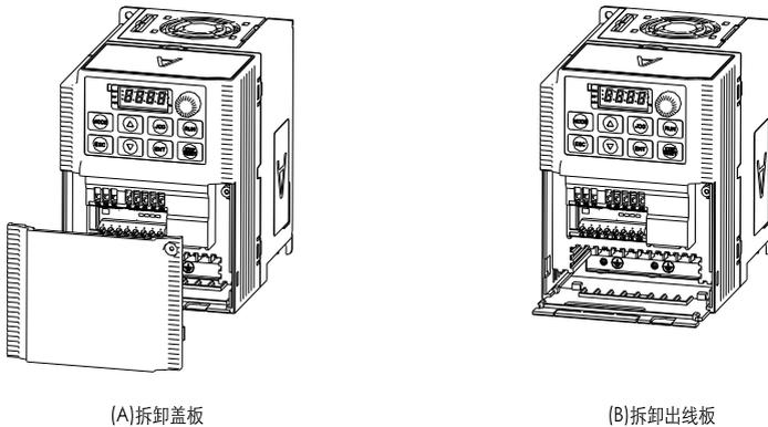
图 3.4 盖板、出线板的拆卸示意图
