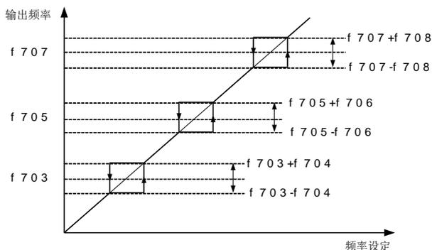
图 5.34 跳跃频率参数设置示意
