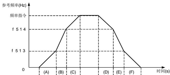
图 5.30 加减速曲线的自动切换
