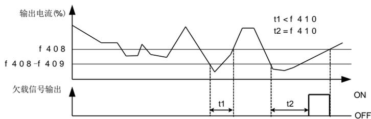
图 5.21 欠载信号输出示意图
