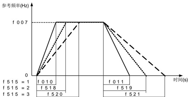
图 5.31 加/减速时间参数
