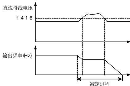
图 5.23 过压故障工作电平示意
