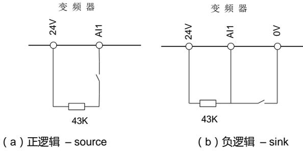
图 3.8 AI1 配置为逻辑输入端子时的接线图
