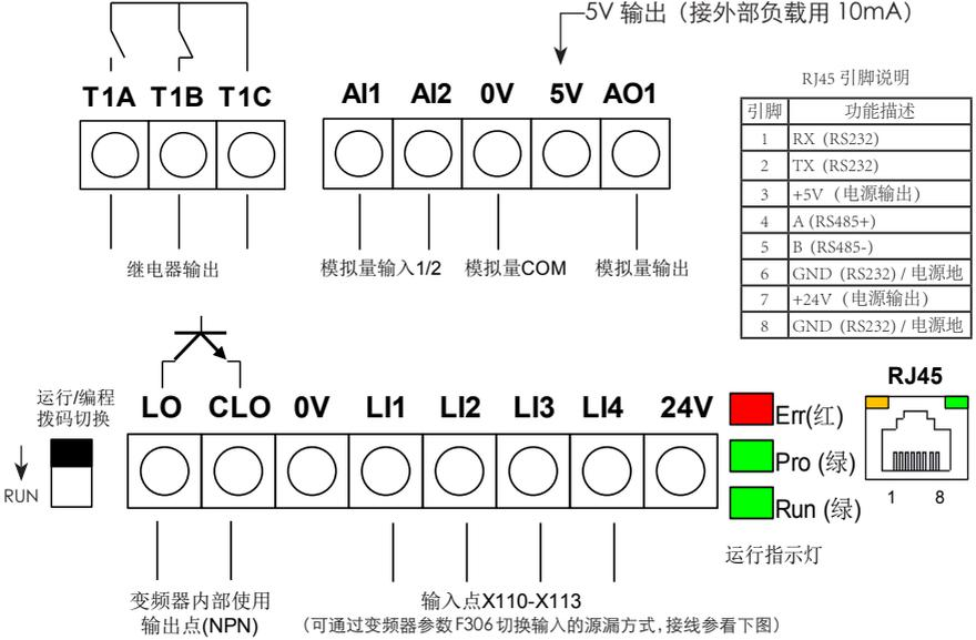
图 6.1 变频器本体接线示意图
