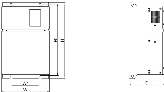
图 2.5 外形及安装尺寸示意图（三相 15kW（含）以上）
