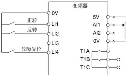
图 4.7 2 线控制接线示意图
